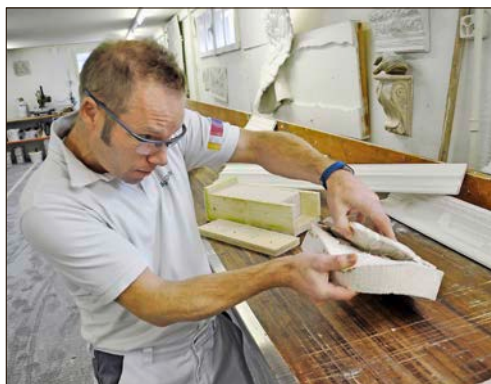
... und er das fertige Ornament aus Gips vorsichtig aus der Form herauslösen kann.
